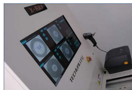
Röntgen-Bauteilezähler „Hawkeye“ von TechValley
